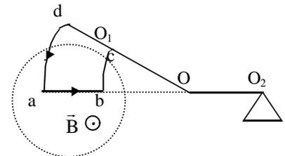
1. Le circuit étant traversé par un courant  $I$ , étudier les conditions d'équilibre de la balance et la possibilité de mesurer l'intensité  $B$  du champ magnétique. On donne  $ab = l$  ;  $OO_2 = d$  ;  $R$  est la distance de  $O$  au milieu de  $ab$ .
