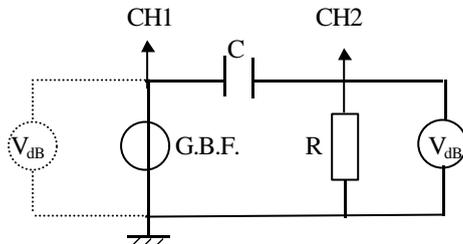
Procéder aux mesures pour  $f \in [0,10 \text{ kHz}, 100 \text{ kHz}]$ , les fréquences étant choisies pour qu'elles se répartissent à peu près également en échelle logarithmique (soit en kHz : 0,1 ; 0,3 ; 0,5 ; 1 ; 3 ; 5 ; 10 ; 30 ; 50 ; 100) tout en multipliant les mesures lorsque les variations du gain ou de la phase sont notables.
